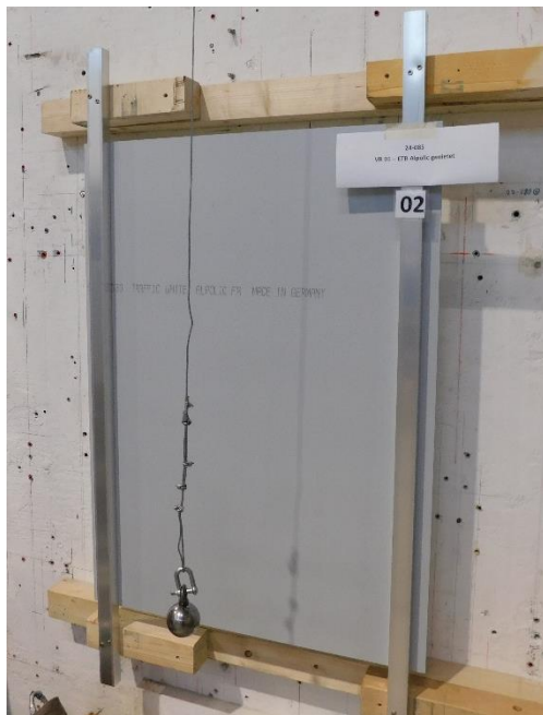
Bild 6: VR02 Prüfaufbau harter Stoß
