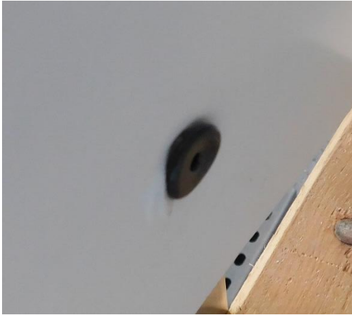
Bild 3 und 4: Verformung im Nietbereich nach weichem Stoß S3
