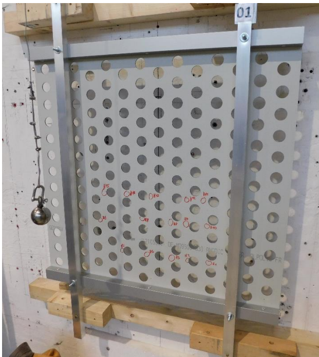
Bild 41: Platte nach 15 durchgeführten harten Stößen
