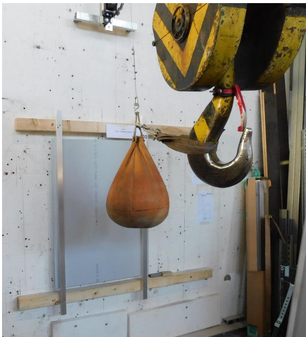
Bild 1: VR01 Prüfaufbau weicher Stoß
