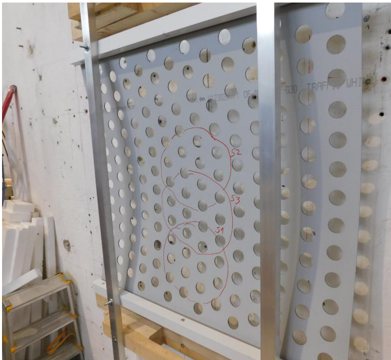
Bild 63: Zustand der Platte nach 3 weichen Stößen
