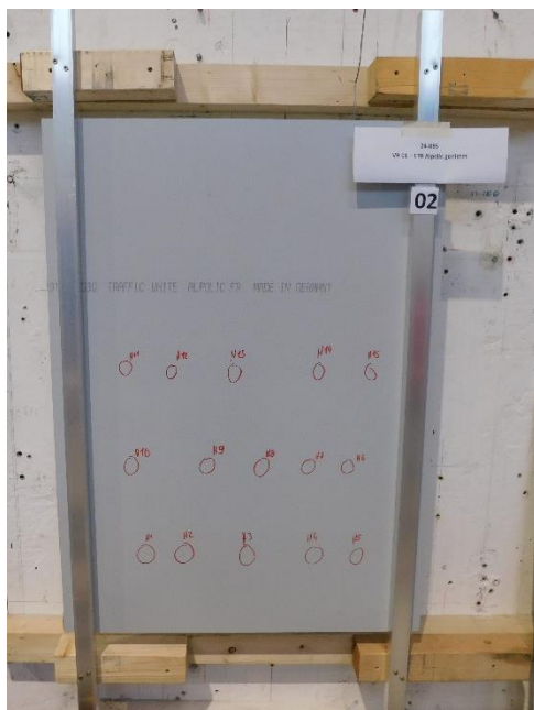
Bild 7: Schlagstellen harter Stoß
