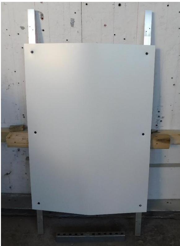
Bild 5: Zustand der Platte nach 3 weichen Stößen, Ansicht der Sichtseite
