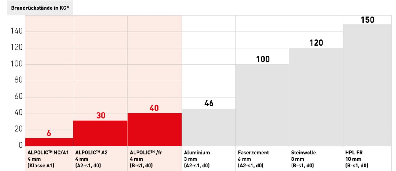
\*Vergleich der Brandrückstände in KG bei BS8414 Großbrandversuchen mit unterschiedlichen Bekleidungsmaterialien.
