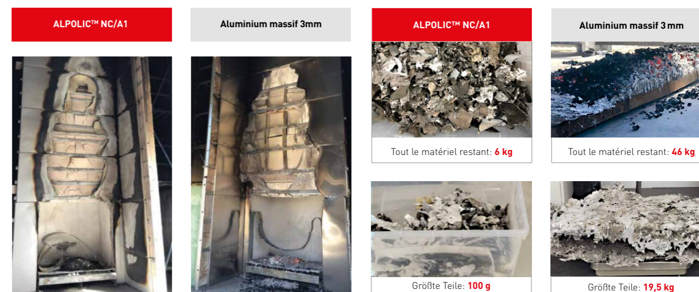
Résultat après un test d'incendie à grande échelle (BS8414-2)
